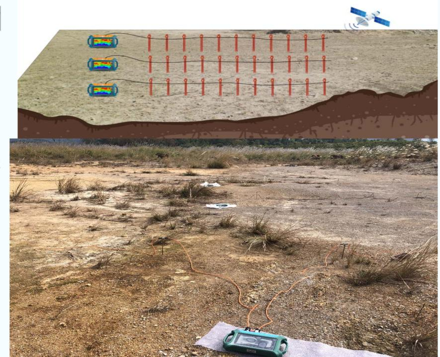
特点:对比单一直线剖 面,多剖面布线方法可 以快速确定异常体的走 向,并且多剖面分析该 地区可以大大提高成功 率。可以使用仪器自带 的数据重组功能来绘制 不同深度的平面剖面图 分析异常体平面走向 了解地下水补给方向 可以准确确定打井位置 为物探开采提供钻探最 优点;
